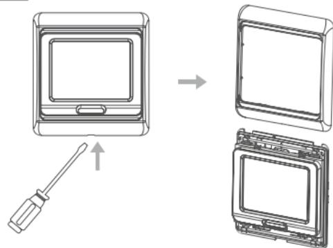
2 С помощью отвертки снимите заднюю крепежную пластину, как показано на рисунке
