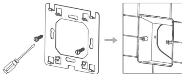
4 После подключения терморегулятора к проводам закрепите прибор на крепежной пластине (см.рис) наденьте лицевую панель и рамку
