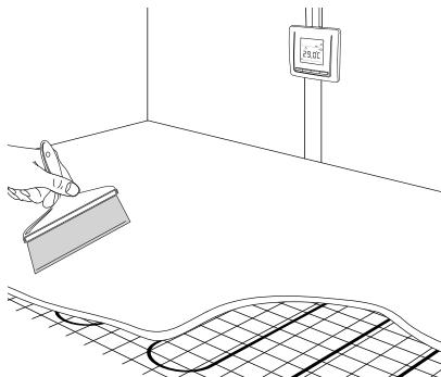
натуальный камень и т. д.) залейте нагревательный мат слоем плиточного клея толщиной 5–8 мм, не допуская образование пузырей, поднятия нагревательного мата.
