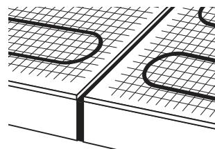
В случае, если здание имеет термокомпенсационные швы, нагревательные маты теплого пола «ТеплоЛюкс» ProfiMat должны быть расположены так, чтобы исключалась всякая возможность прохождения кабеля нагревательного мата через шов.
