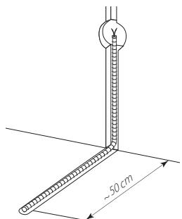
\* Распаечная коробка используется в случае подключения к одному терморегулятору 2-х матов. Не входит в комплект поставки.
