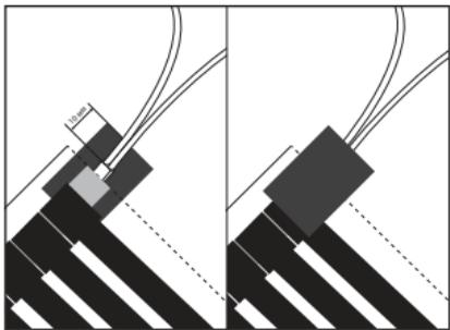
Рисунок 20. Правильная изоляция электрических соединений (зажимов).
