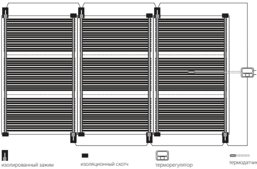
Рисунок 5. Общая схема подключения нагревательной пленки к терморегулятору в случае расположения установочных проводов непосредственно под напольным покрытием без дополнительной защиты от механических воздействий (вид снизу).
