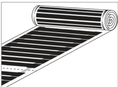
Рисунок 12. Правильная ориентация нагревательной пленки в теплом полу (médные токопроводящие шины должны располагаться внизу).
