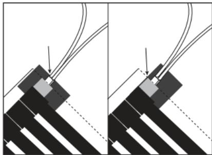
Рисунок 21. Примеры неправильной изоляции зажимов.
