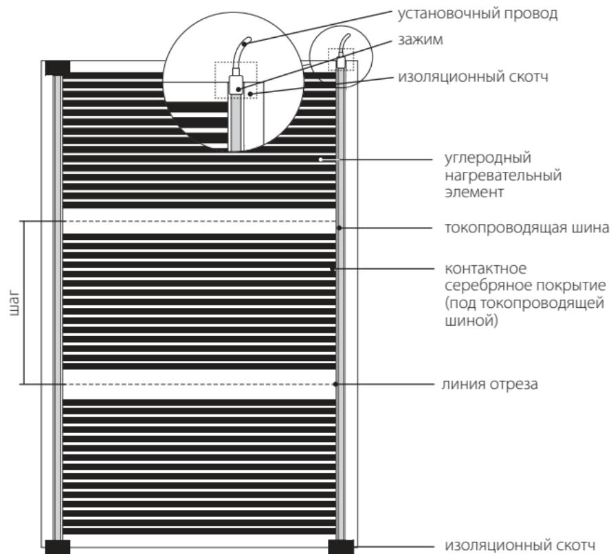
Рисунок 2. Конструкция нагревательной пленки (вид снизу)
