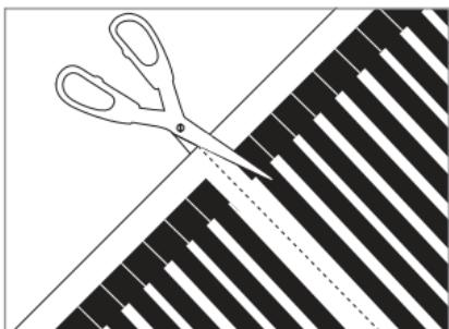
Рисунок 10. Раскрай нагревательной пленки на полосы нужной длины строго по линии отреза.
